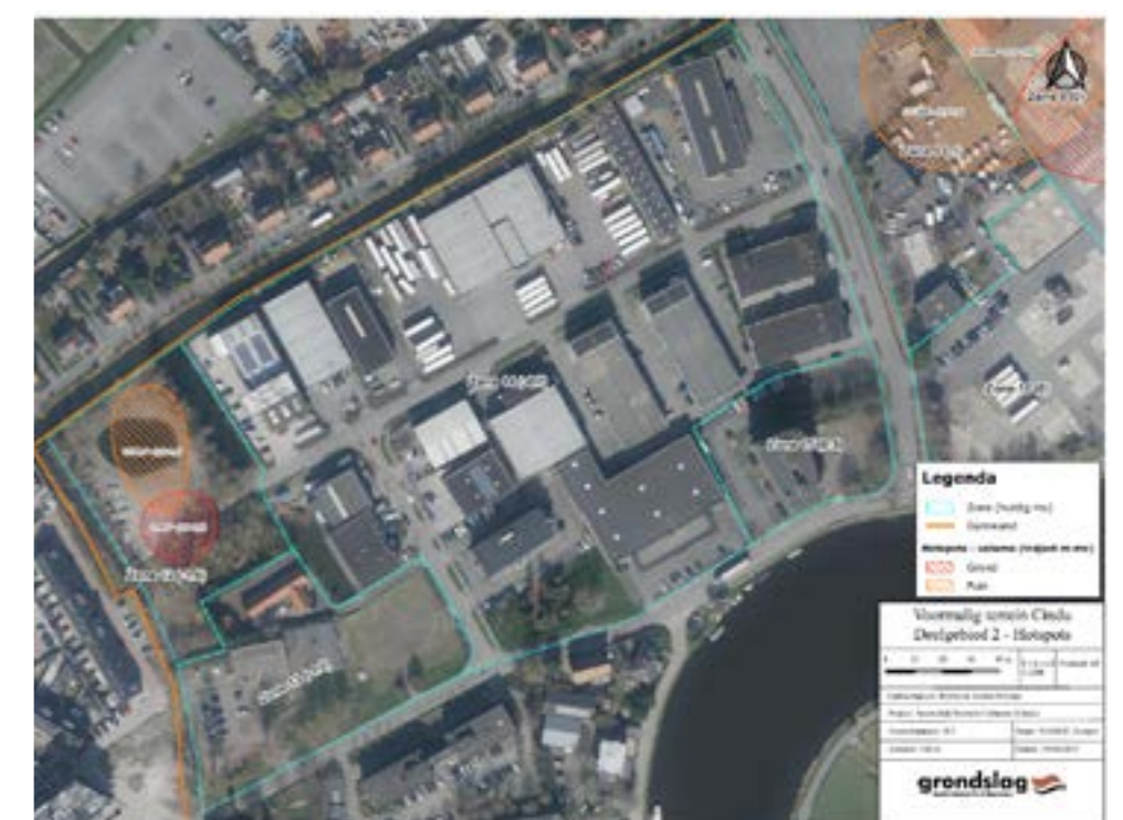
De aanwezigheid van 'hotspots' binnen het gebied: clusters van verontreinigingen met teerachtige materialen.
