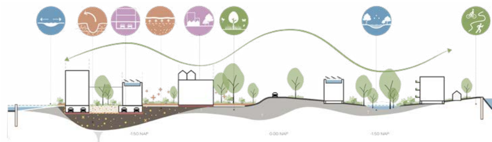
Een schematische doorsnede door deelgebieden II en IV: het benutten van het ontgraven van hotspots, een afdichtende laag op resterende verontreinigingen en extra ruimte voor waterberging in delen waar sprake is van bovengemiddelde bodemdaling.
